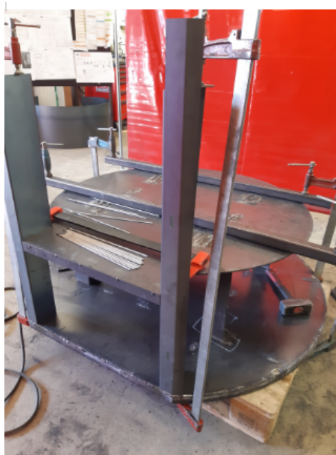
(3) mise en place du foyer
