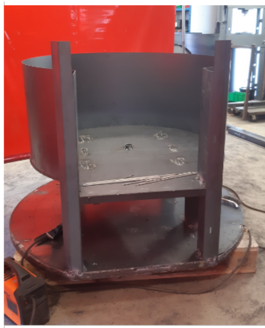
(4) mise en place de la chambre de cuisson
