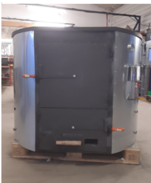
(7) Le four fini !!! Les 2 portes pour le foyer et la chambre de cuisson. Avec un thermomètre et une entrée d'eau
